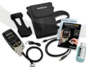
Se entrega completo con cuerpo de medidor PosiTector, sonda UTG CLF, acoplante (gel ultrasónico), funda protectora de goma, correa de muñeca, 3 baterías alcalinas AAA, instrucciones, protector de lente, estuche de transporte práctico, Certificado de Calibración de Forma Larga trazable al NIST o PTB, cable USB, software PosiSoft y dos (2) años de garantía.
