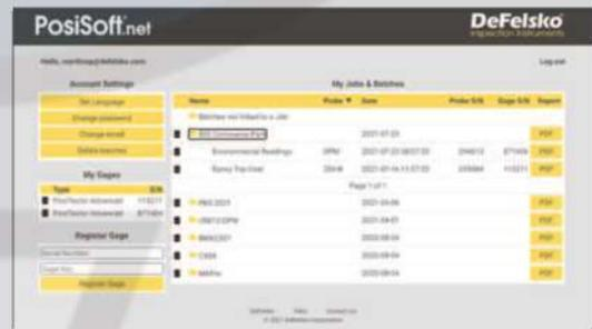
PosiSoft.net Revisa los datos de medición e imprime informes PDF simples y preformateados desde cualquier navegador web, sin necesidad de instalar software.
