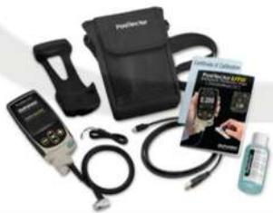
Se entrega completo con cuerpo de medidor PosiTector, sonda UTG C, acoplante (gel ultrasónico), funda protectora de goma, correa de muñeca, 3 baterías alcalinas AAA, instrucciones, protector de lente, estuche de transporte práctico, Certificado de Calibración de Forma Larga trazable al NIST o PTB, cable USB, software PosiSoft y dos (2) años de garantía.
