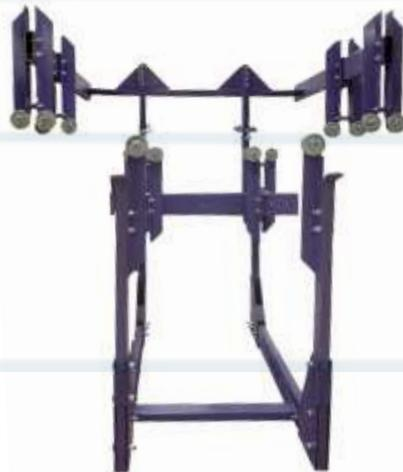
Sistema de manejo de carro utilizado para limpiar paredes internas en tanques con tapa no removible o sellada y cascos de barcos (Requiere de 8 beam trolleys).
