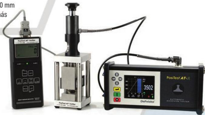
**Los probadores de adhesión incluyen todo lo necesario para pruebas:** Probador de adhesión, batería NiMH recargable incorporada con cargador, extractores, almohadilla abrasiva, herramienta de corte, pegamento con varillas y paletas de mezcla, bastoncillos de algodón, cable USB, software PosiSoft, folleto de instrucciones y video, correa para hombro (solo AT-A), Certificado de calibración trazable a NIST, garantía de dos años, y estuche de transporte resistente y liviano
