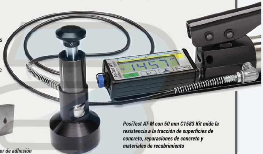
PosiTest AT-M con 50 mm C1583 Kit mide la resistencia a la tracción de superficies de concreto, reparaciones de concreto y materiales de recubrimiento
