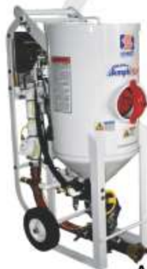
AmphiBlast Lite Capacidad Tolva: 3,5 cu.ft Blast Pot: 3,5 cu.ft
