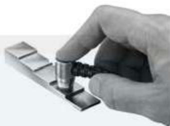
Cuando la sonda detecta los ultrasonidos del eco, un símbolo de acoplado ▼ aparecerá en la pantalla y los valores del espesor se mostrarán. Mientras la sonda esté acoplada, el **PosiTector UTG** actualizará de manera constante la pantalla. El instrumento emitirá un sonido parecido a un "tick" cada vez que el sensor adquiere un dato de espesor. Para desactivar la opción de sonido "**Tic de Lectura**" confirmando cada lectura ingrese al menú "**Configurar**" (Ver pág.12).
