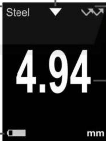
Modo de medición actualmente configurado como multieco (Solo para sondas UTG M / UTG P)
