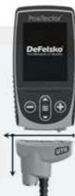
Adicionalmente, el cuerpo del **PosiTector** es compatible con una amplia variedad de sondas de tipo magnético, eddy current, ultrasónica para espesor de película de recubrimiento, perfil de superficie, condiciones ambientales, dureza, contaminación por cloruros, brillo, y ultrasónicas para espesor de pared. Ver [www.defelsko.com/probes](http://www.defelsko.com/probes)
